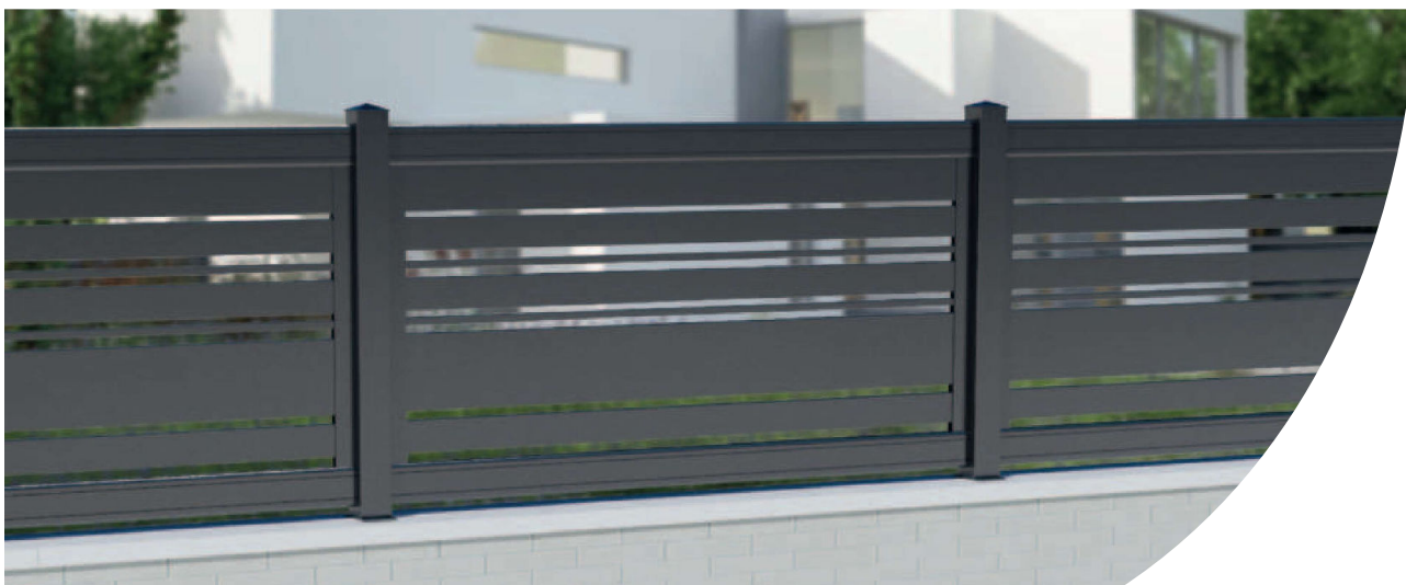
Coloris RAL 7016 FT - avec poteaux 80 x 80 mm Dimensions maxi. entre poteaux : 2000 mm pour poteaux de 80 x 80 mm, 1500 mm pour poteaux de 70 x 70 mm
